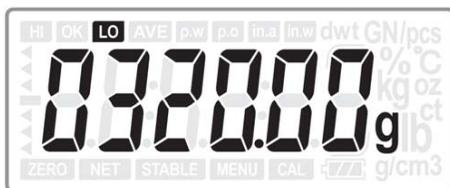
Pozor – při nastavení limitních hodnot nesmí být žádná z hodnot vyšší, než je maximální váživost dané váhy a současně hodnota dolního limitu musí být logicky vždy nižší, než je hodnota horního limitu. Jinak váha vyhlásí chybu „Err4“.
