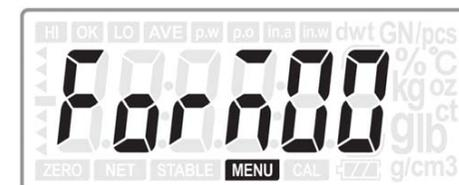
V případě nastavení počítače nebo mikrotiskárny (**tr.A.P** nebo **tr.SEr**) a potvrzení váha následně požaduje zadání formátu protokolu. Je třeba zadat jeden z protokolů **1** až **3** a aktivovat jej do stavu „**ON**“
