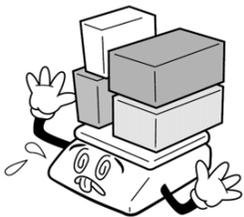
Nepřetěžujte vaši váhu výrazně nad její deklarovanou maximální váživost. Při přetížení více než 20% přes max. váživost by mohlo dojít ke zničení snímače zatížení ve váze.
