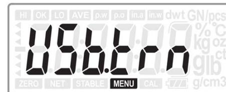
Tlačítka **>T<** a **A** zvolte požadované připojené zařízení dle tabulky výše.
