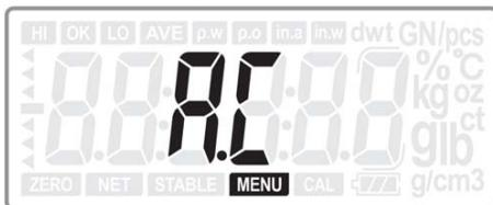
Tlačítka **▶◀** a **A** aktivujte funkci automatického přepočítávání jednotkové hmotnosti na „A.C ON“.
